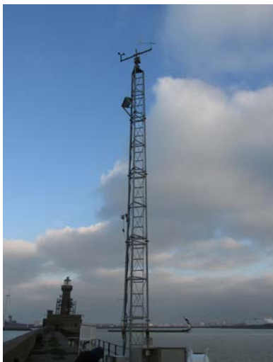
Afbeelding 9: Het automatisch weerstation (onder) en de LIDAR (boven) in Zeebrugge.
