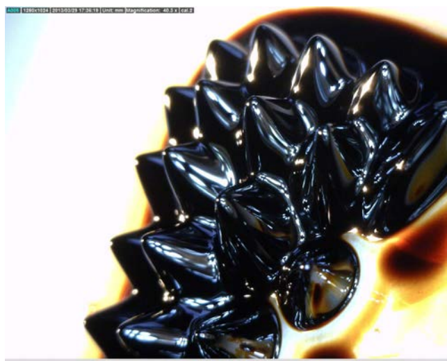
Afbeelding 19: Foto van een vloeistof die nanometrische deeltjes van ijzeroxyde bevat (ferrofluidum), onder invloed van een permanente magneet. De pieken, die slechts verschijnen onder invloed van een magnetisch veld, visualiseren de krachtlijnen opgewekt door de magneet.
